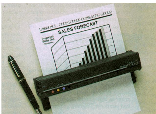
vidite na slici, jedva malo veće od naliv pera. A ipak, u pitanju je *ink-jet* printer koji štampa na standardnom papiru, u rezoluciji 360\*360 tačaka po inču koja je uporediva sa rezolucijom većine laserskih štampača. Ne očekujte od njega silnu brzinu štampanja - papir se umeće list po list, a štampanje traje od 30 sekundi (čist tekst) do par minuta. Cena nije baš džepna: 430 dolara.
